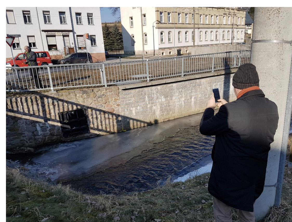
Abb. 7: Messteilnehmer beim Messen des Wasserstands (Eisdecke) mit dem Smartphone.
